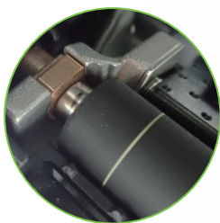
Weißer Linie auf einer neuen PureLine™-Druckplattenwalze.
